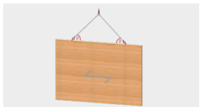
Parete o supporto BSH verticale, fibratura: orizzontale
