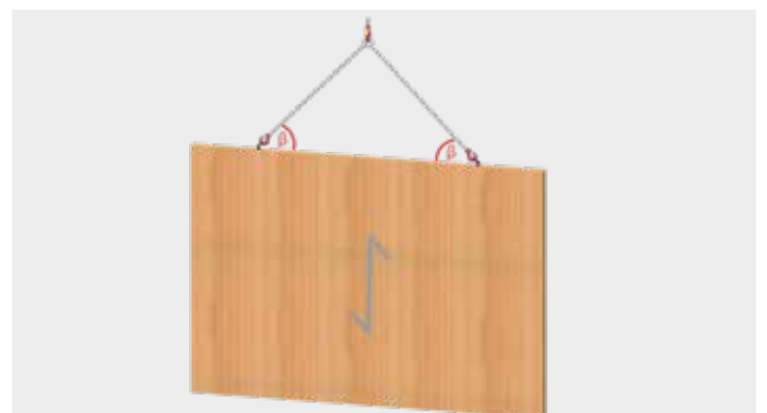
Parete o supporto BSH verticale, fibratura: verticale
