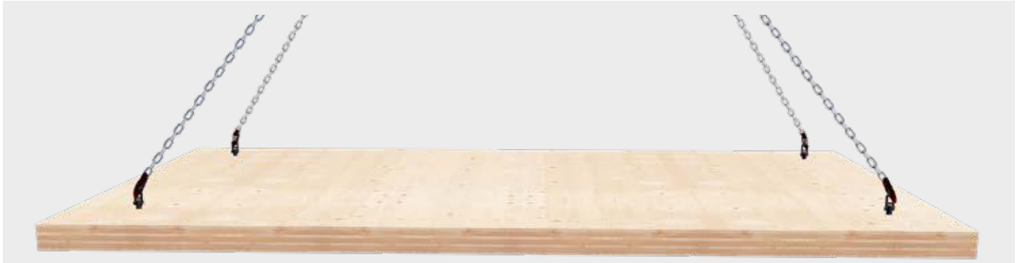
Horizontaler Transport von z. B. Deckenelementen.
