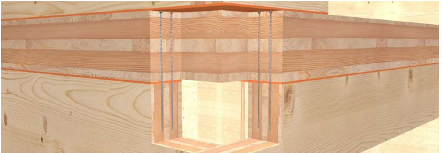
Verbindung von Wand- und Deckenelement.
