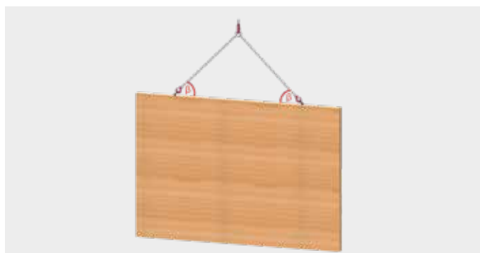
Mur ou poutre en bois lamellé collé en position dressée, orientation des fibres : verticale
