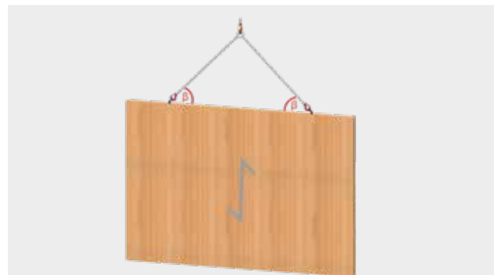
Mur ou poutre en bois lamellé collé en position dressée, orientation des fibres : verticale
