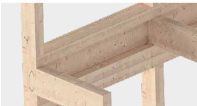
Fixation de supports sur des ossatures en bois et raccords de poutres principales et secondaires
