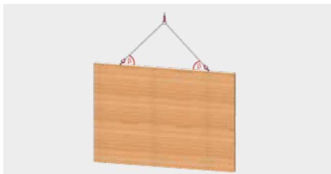
Mur ou poutre en bois lamellé collé en position dressée, orientation des fibres : horizontale
