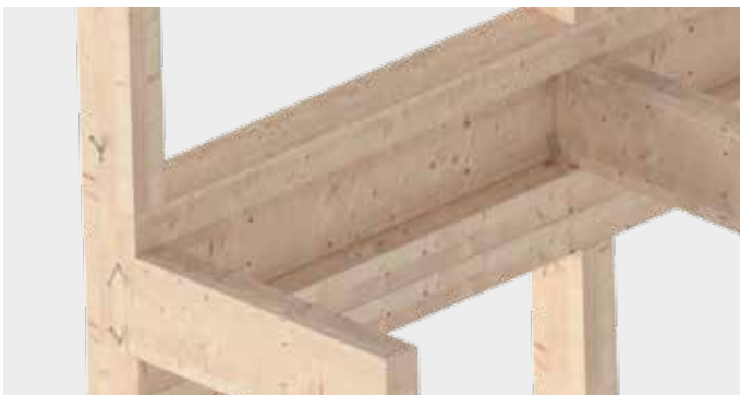
Mocowanie podpór w drewnianych konstrukcjach ramowych oraz połączeniach dźwigarów głównych i drugorzędnych
