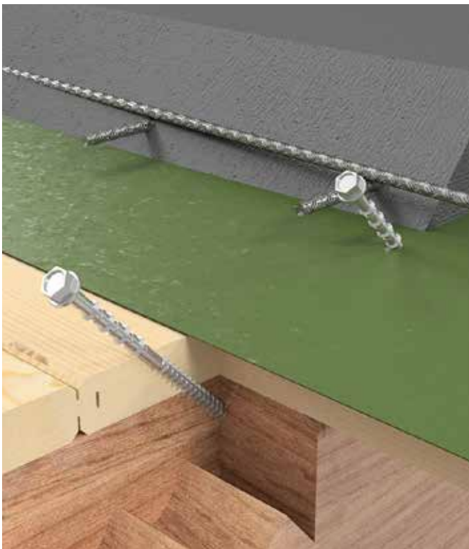
Topfloor (beton na górnej stronie)
